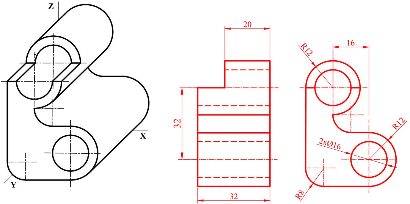
**4.2.-** Dadas las vistas normalizadas de una pieza, representar la vista cortada por el plano AA. Acotar según normativa para su correcta definición dimensional.
