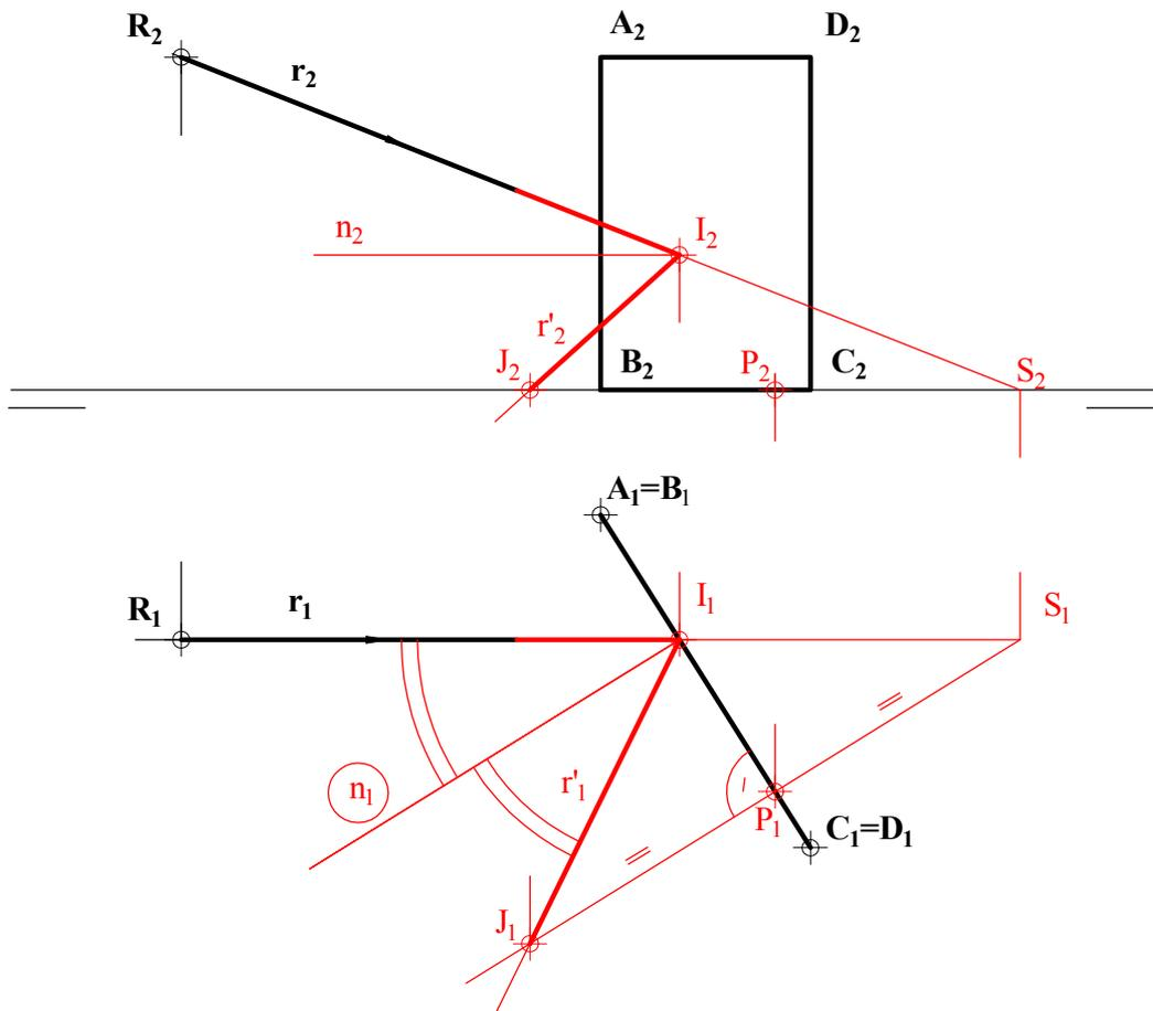
**2.2.-** Determinar la sección producida por el plano  $ABC$  en el prisma pentagonal regular recto de 45 mm de altura, cuya base dada está situada en el plano horizontal de proyección.
